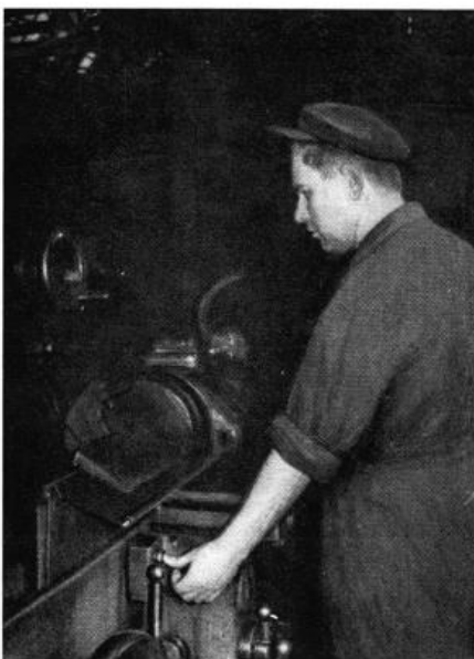
Панель расположена в удобной зоне, и шлифовщику легче манипулировать кнопками.
